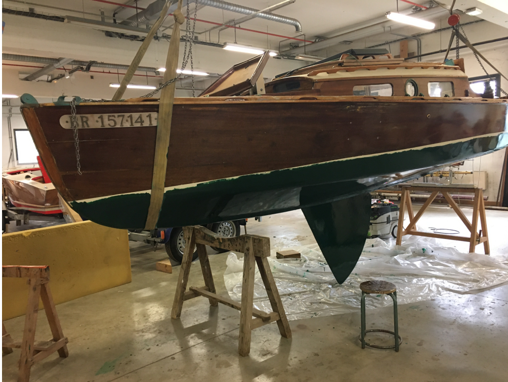
Puits de dérive, capot arrière, vernis et antifouling
